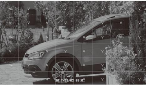
Vマークが表示されているエリアのみ検知します。
